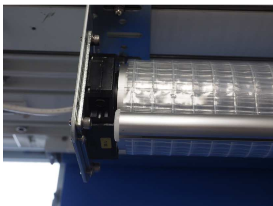
⑥モーターをブラケットに固定します。
